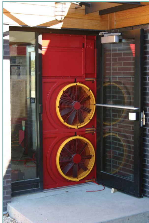
Figure 4-5 Infiltromètre à deux ventilateurs; cet appareil convient à la plupart des immeubles de petite et de moyenne taille.
